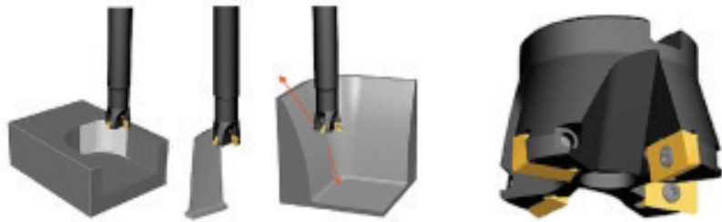
Fig. 20: Schema di fresa per penetrazione assiale Axial milling example
